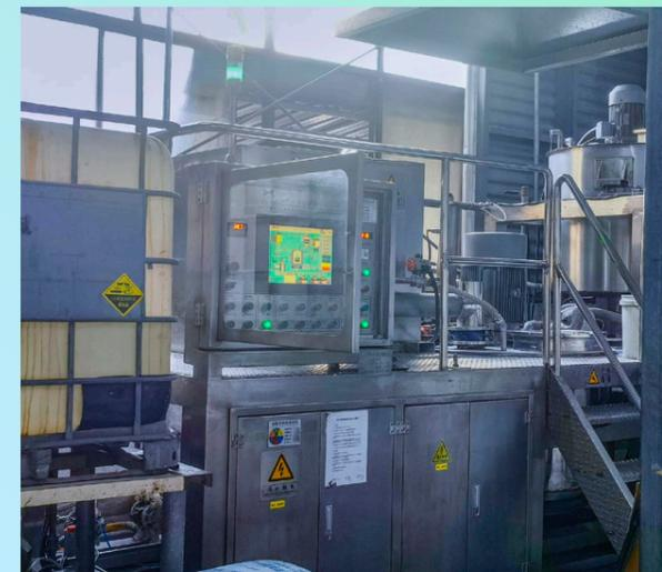
无锡新通联针对回收机电泵冷却水流进行了技术改造,有效实现了冷却水的循环利用。通过增设 5 吨储水桶和配套小功率循环泵,我们成功回收原本直接排放的冷却水,每天减少新鲜自来水使用约 10 吨,每年节约水资源约 3,000 吨。
